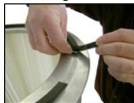
2. Assemble the four sets of clamps as shown in the diagram below. Put one clamp on each side of the filter, spacing them evenly around the filter. (Fig. 4) / Assemblez les quatre ensembles de bornes comme indiqué sur le schéma ci-dessous. Mettre une pince sur chaque côté du filtre, en les espaçant de façon égale autour du filtre. (Fig. 4)
